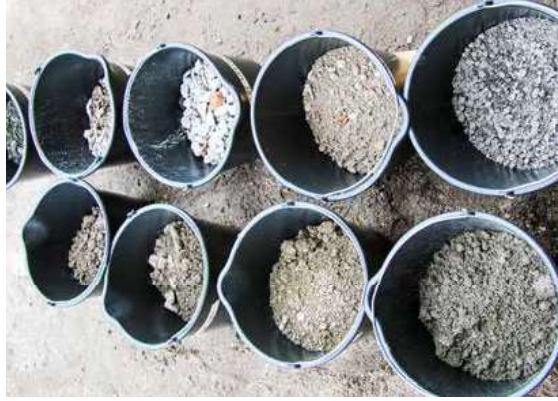
Et utvalg testmasser ble vist fram under demonstrasjonen. I høttene til høyre ligger de ublandede produktene. Raden til venstre viser den ferdige blandingen av gammel vegmasse og testprodukter.
