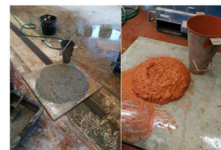
Figure 2 a) Slump test of E1, b) Slump test of E10
