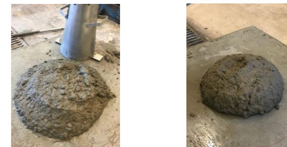
Figur 3: God synk med knust tilslag (venstre) og dårlig synk med tunnelmasser (høyre).
