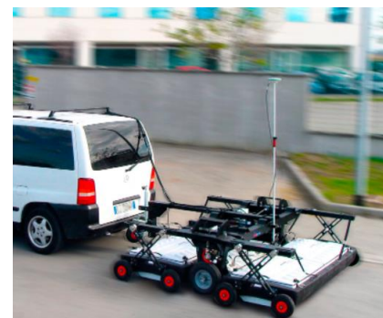
Figur 1 GPR-utgave: Stream EM
